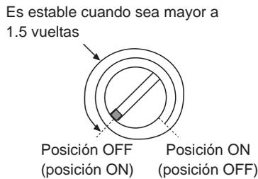
■ Si se sitúa la posición de ajuste de sensibilidad del potenciómetro al centro entre ■ y ■, el ajuste de sensibilidad se habrá completado.
